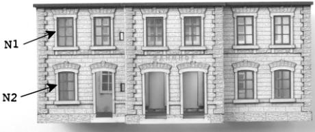
Der Haupttrakt kann nun mit den äußeren Fenster versehen werden. Dabei werden die ausgeschnittenen Fenster N1 mit der Folienseite nach unten in die obere Etage und N2 in die untere geklebt. Der breite Querbalken muss auch hier immer oben sein.
